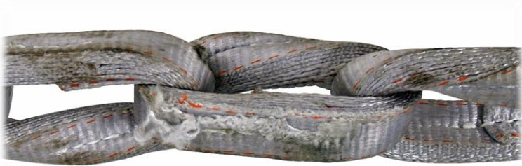
Abb. 3: Abrieb an der Oberfläche des Kettenglieds
