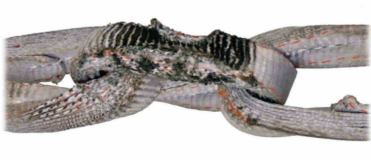
Abb. 6: Gewebeschäden durch Wärmeeinwirkung
