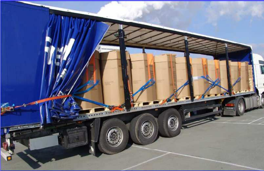
Abb. 3: DoUniFlex Sicherungssysteme auf dem Lkw angebracht.
