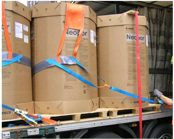
Abb. 7: Anschließend das Losende des DoUniFlex-Sicherungssystems mit einem Festende eines Standardgurtes verbinden und unter einem Zurrwinkel \alpha von ca. 30° sichern
