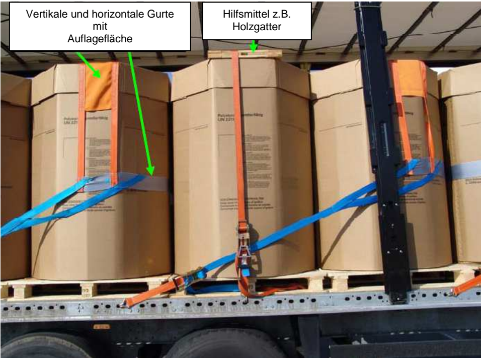
Abb. 9: Beispiel zur Sicherung der Oktatainer ® mit dem DoUniFlex-Sicherungssystem (Standard) sowie durch Niederzurren. Hierbei wurde ein Holzgatter als Hilfsmittel eingesetzt, um den Oktatainer ® nicht zu beschädigen
