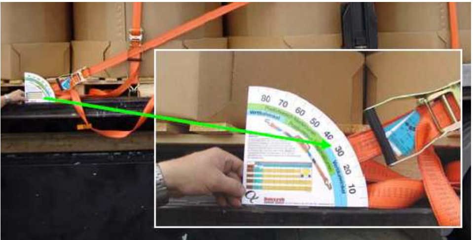
Abb. 8: Berücksichtigung des Zurrwinkel \alpha von ca. 30°
