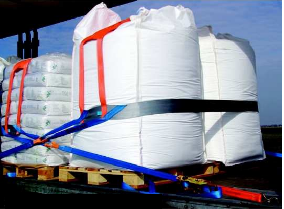
Abb. 11: Beispiel zur Sicherung von BigBags und Sackware mit dem DoUniFlex Sicherungssystem (Standard).
