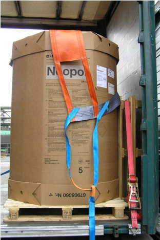
Abb. 6: Das DoUniFlex-Sicherungssystem über die Ladung (hier Oktatainer ®) legen
