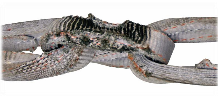
Abb. 6: Gewebeschäden durch Wärmeeinwirkung
