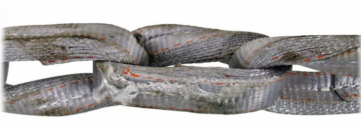
Abb. 3: Abrieb an der Oberfläche des Kettenglieds
