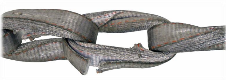
Abb. 2: Durchtrennte Gurtbandlage außen.
