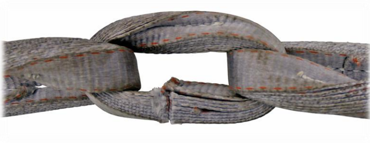
Abb. 4: Einschnitt im Kettenglied
