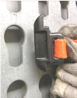
Abb. 5: Die Fittinge sind mit einem Pfeil gekennzeichnet dieser muss nach oben zeigen
