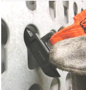
Abb. 6: Den Fitting schräg in das Schlüssellochprofil einführen
