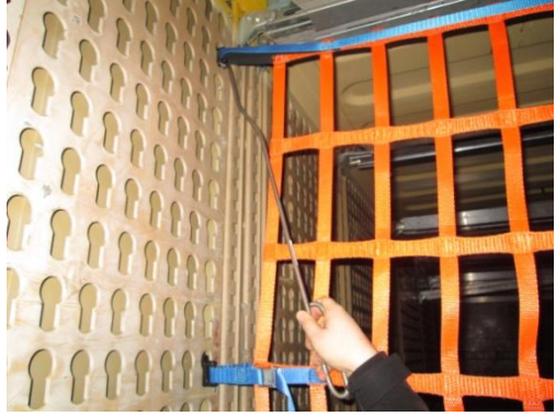
Abb. 8: Um die oberen Fittings leichter in das Schlüssellochprofil fixieren zu können, kann das Trennnetz leicht von Hand nach unten gezogen werden..
