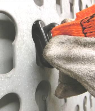
Abb. 7: Den Fitting gerade in das Schlüssellochprofil ausrichten
