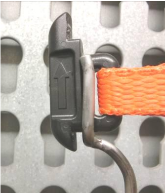
Abb. 12-13: Für den Überkopfeinsatz kann die Montagehilfe verwendet werden. Dazu Fitting auf die Montagehilfe stecken.
