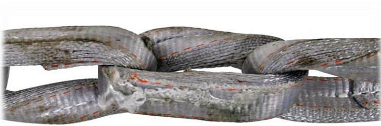
Abb. 3: Abrieb an der Oberfläche des Kettenglieds
