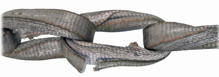
Abb. 2: Durchtrennte Gurtbandlage außen.
