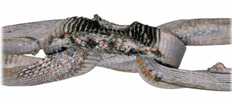
Abb. 6: Gewebeschäden durch Wärmeeinwirkung
