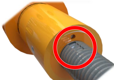
Abb. 4: Ausfräsung am Spindelgewinde
