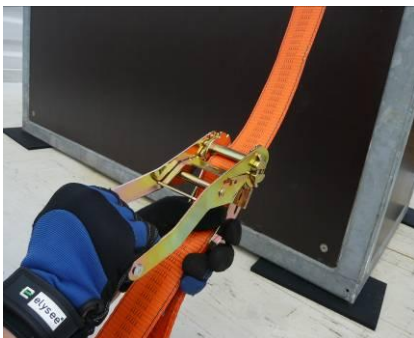
Abb. 4: Spannen durch Auf- und Abwärtsbewegungen des Handgriffs, bis die gewünschte Vorspannkraft erreicht ist. Ratsche nach dem Spannen schließen
