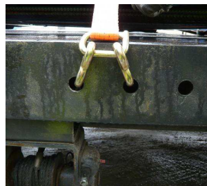
Abb. 17-18: Der DoConnect- Haken des DoZurr 8000 ist wahlweise als Profil- oder U- Profilhaken einsetzbar
