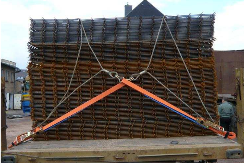
Abb. 16: Die Profilhaken des DoZurr 8000 in die Seilöse (Seilkausche) des Seilsystems einhängen. Die DoConnect-Haken in die Zurrpunkte des Aufliegers einhängen
