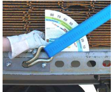
Abb. 14: Den Profilhaken des DoZurr 8000 - kraftverstärkt in das Außenrahmen-Lochprofil des Fahrzeugs einhängen. Zurrwinkel \alpha ca. 30^\circ (hier verstärkte Ausführung).
