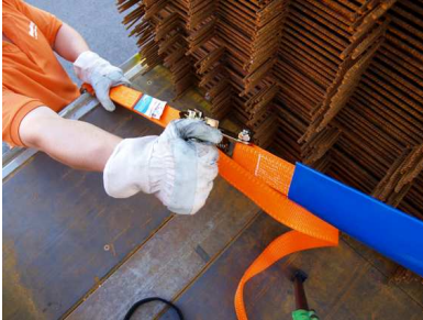
Abb. 19: Erster Schritt: DoZurr 8000 (Querrichtung) vorspannen
