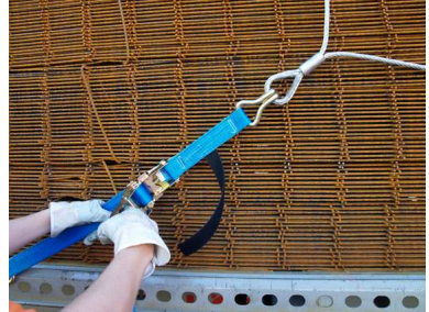
Abb. 20: Zweiter Schritt: DoZurr 8000 - kraftverstärkt oder DoZurr 5000 (Längsrichtung) vorspannen.
